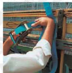
2 - Passe a fita pelo vão no eixo da catraca;
